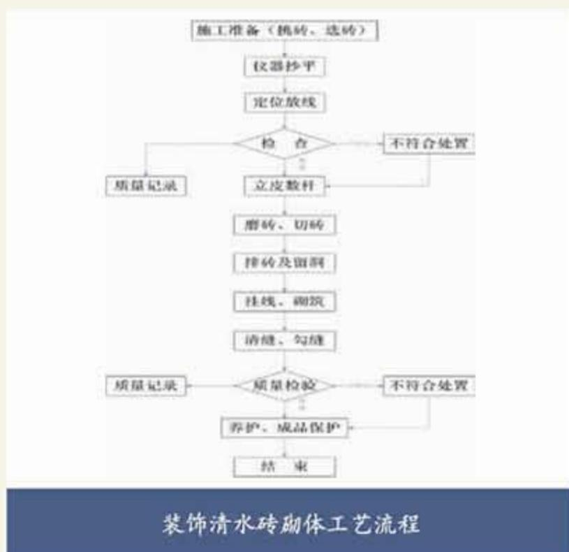
大面，将砖的厚度磨至54mm，另一台磨砖的另一侧大面，将砖的厚度磨至53mm。使青砖的尺寸规格一致、棱角顺直。磨好的砖每五个用棉毡一裹，用绳扎起来，轻拿轻放，分堆码放，做好砖在上墙前的保护工作。
