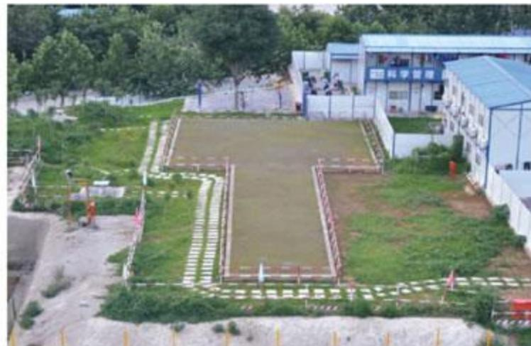
本工程西北角有一“西汉壁画墓”，距基坑边沿不足6米，基坑土方支护以及基坑监测要求高，我项目部通过和设计院沟通，在紧靠墓区的周边，浇筑70根直径0.9米、长20米的混凝土灌注桩，并用槽钢制作三道腰梁，最后进行护坡喷浆施工，有效保护了古墓不被扰动，同时减少土方开挖量。在古墓外围铺贴预制混凝土盖板，便于参观，同时对裸露地面进行大面积绿化，最大程度保护了墓区原始地貌。在400m<sup>2</sup>的古墓核心区，搭设工具式隔离栏杆，防止人员跨越，有效保护文物。
