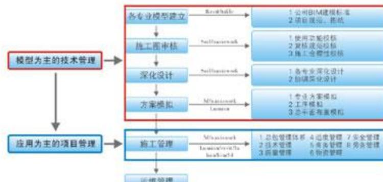
基于BIM的总包管理体系流程图
