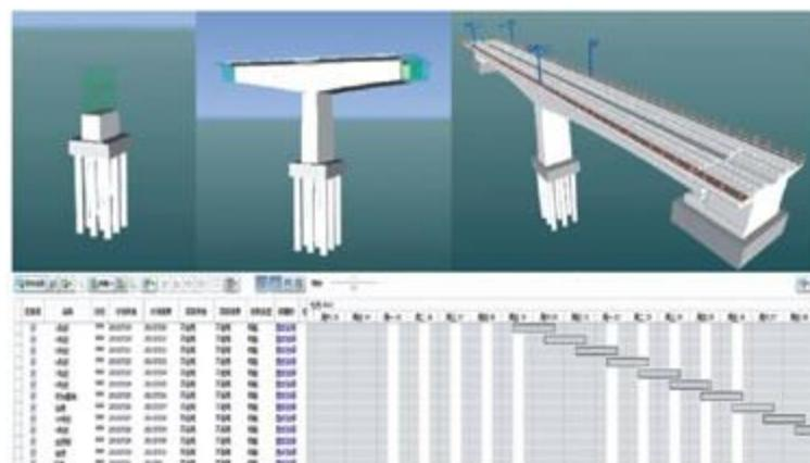
图5 十岔沟中桥施工模拟
