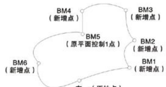
图4 闭合水准测量线路图
