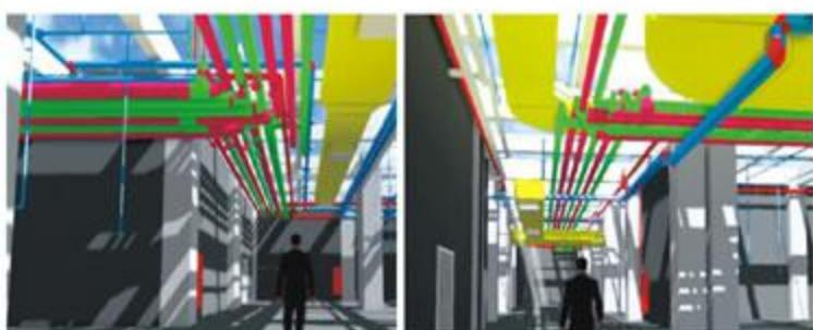
本项目借助BIM模型在安装工程开展进行了标准层、裙楼、地下室的安装BIM模型技术会审，会同设计单位，建设单位，监理单位确定了重点部位的施工模型，会审合格后出具深化图纸进而用于现场施工。
