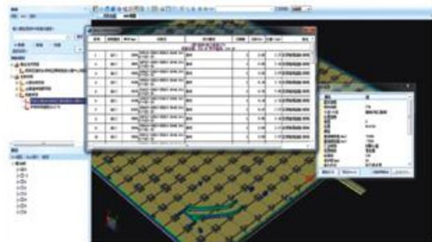
图9 CT9承台各规格钢筋用量
