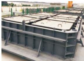
图16 固定模台安装完成
