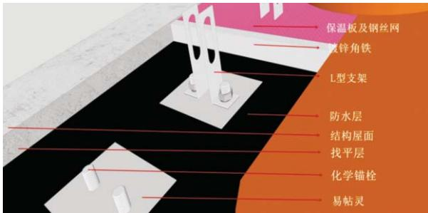
图3-13 金属骨架干挂瓦屋面结构层施工示意图
