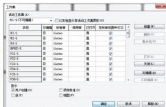
图2 展示在Revit Architecture中建立的工作集
