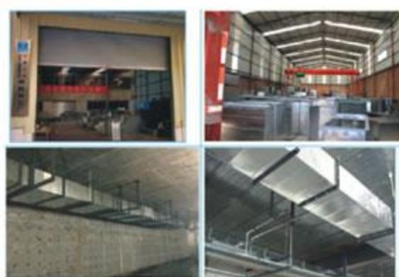
图20 风管工厂化预制加工
