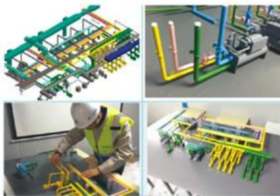
图21 3D打印技术指导工厂化预制加工
