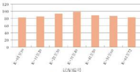
图2.各试配的平均初始坍落度分析
