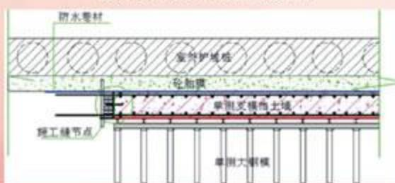
图5.2.4流水段间施工缝处理
