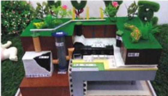
车库顶板虹吸雨水收集系统模型
