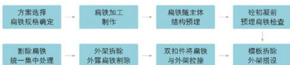
图二 扁铁连墙件工艺流程
