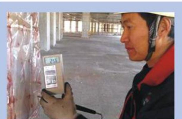
图4-1 泵管、蒸汽管道间温度
