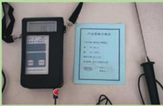
图3-11 JDC-2型建筑电子测温仪
