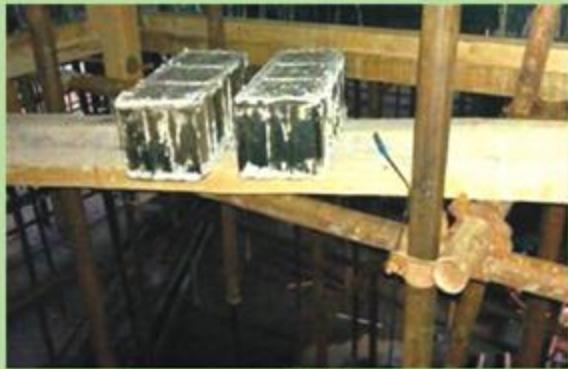
图3-12 同条件试块及测温探头
