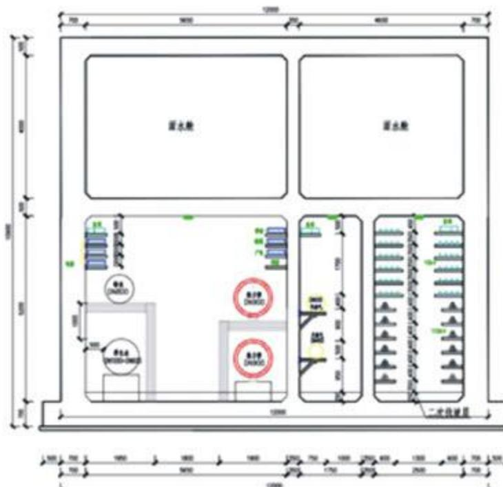
图1 综合管廊标准断面图
