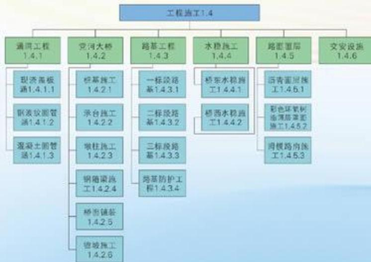
图2.3工程施工分解图
