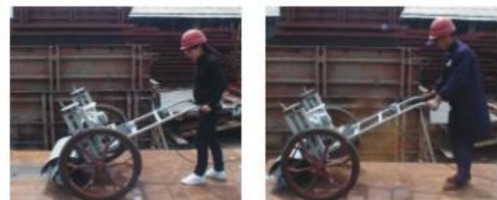
5) 钢刷组除锈打磨面积大，动力装置强，除锈彻底，效果好。
