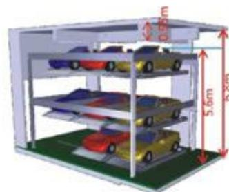
图4-3-1 (b) 3层机械车位标高要求
