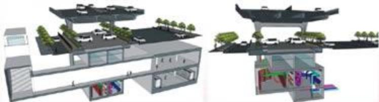
图3 昆明路地下综合管廊地铁人行通道处断面图
