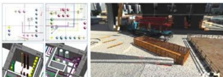
图29 组合立管整体吊装方案模拟
