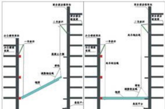
图10 底层钢梁起吊夹角示意图 图11 底层钢梁吊装落位示意图
