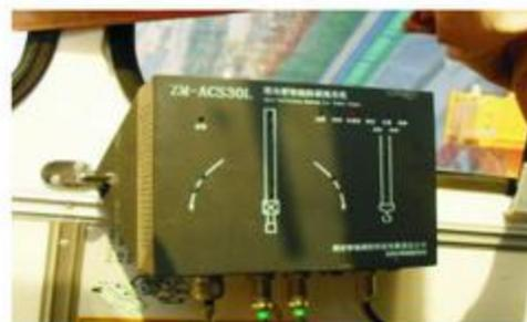
10、采用变频式塔吊并设置塔吊防碰撞系统和塔吊防倾斜装置，能够全方位保证塔机的安全运行。
