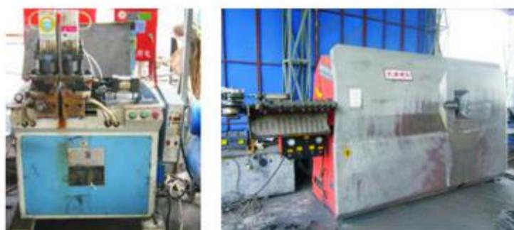
12、引进技术先进的材料设备钢筋数控弯箍机，在钢筋制作环节不仅满足了施工质量需要，还提高了钢筋制作环节的精细化和准确性，使盘园类钢筋损耗降低到万分之一。
