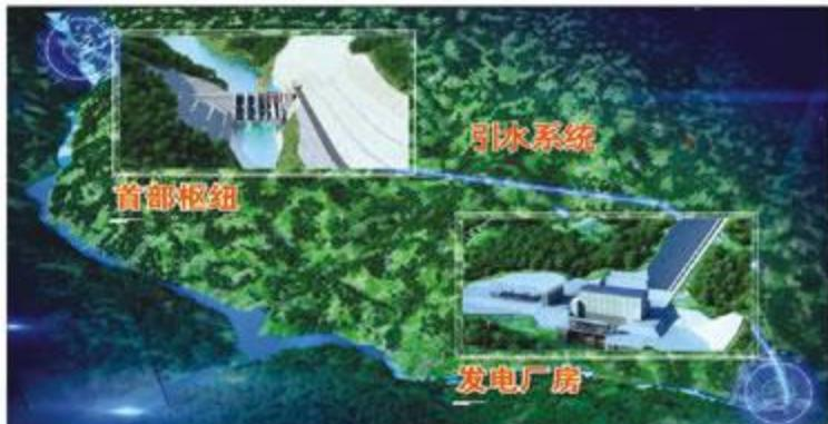
图1 厄瓜多尔德尔西水电站工程布置图
