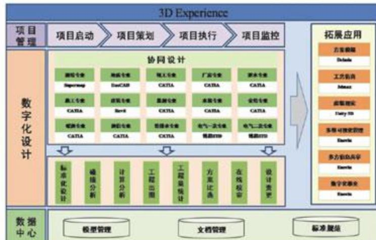
图2 BIM应用平台架构
