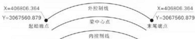
300mm分线，当连接线长度大于5m时每隔500mm分线），以上工作在CAD中计算完成后并标记清晰，现场以此为依据进行分线。
