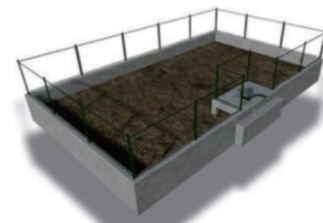
泥浆排入泥浆池集中堆放
