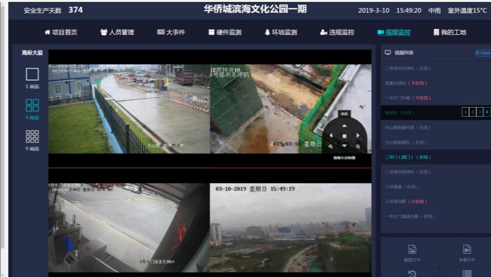
运用视频监控系统辅助施工现场管理，对主要作业面工序质量和安全文明施工进行监控，并通过网络将视频信号传输至智慧工地管理平台，实现协同管理。
